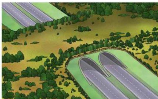
Esquema general de un ecoducto (Fuente: Prescripciones técnicas. Ministerio de Agricultura, Alimentación y Medio Ambiente. 2015)
