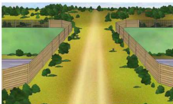
Esquema general de un paso superior multifuncional (Fuente: Prescripciones técnicas. Ministerio de Agricultura, Alimentación y Medio Ambiente. 2015)
